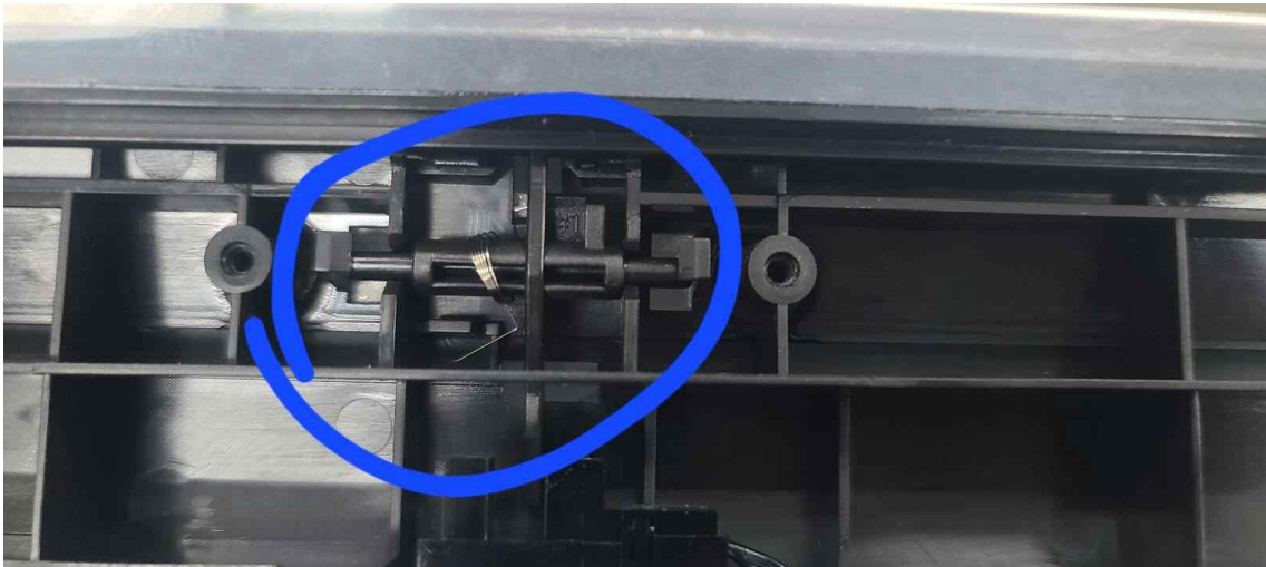
레지스트 센서 스프링 불량 스큐 잼 발생 스프링 재장착
